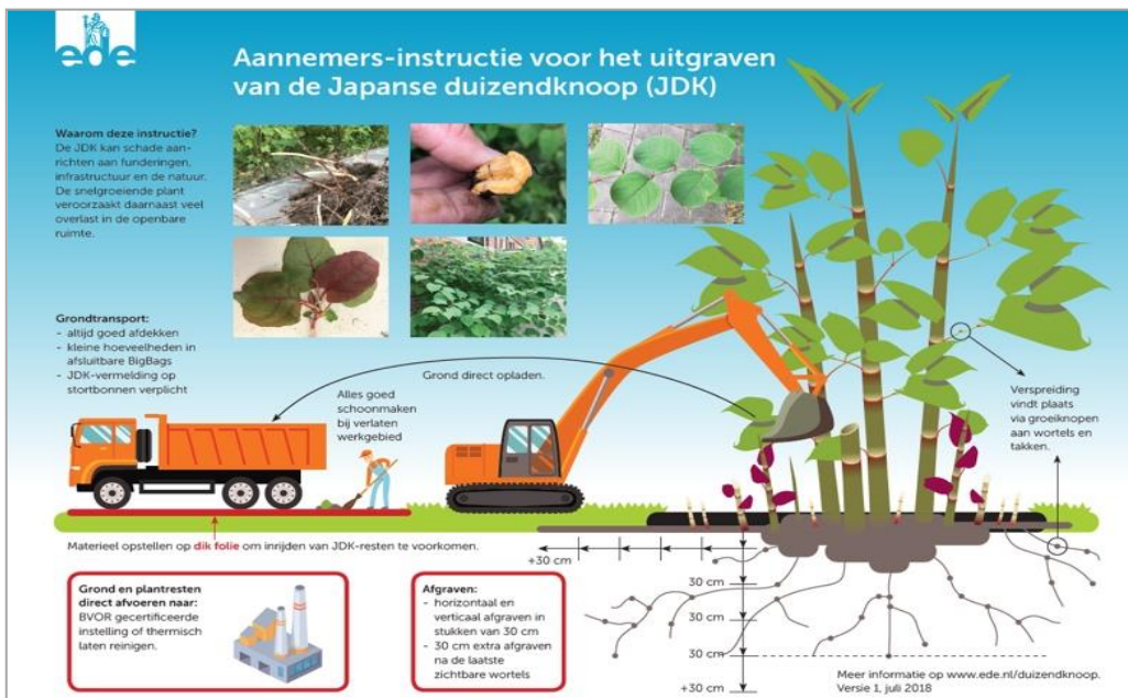
Aannemersinstructie uitgraven van Japanse duizendknoop
